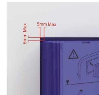
4 Теперь можно сооружать стену и делать чистовую отделку/класть плитку вокруг инсталляции. Используйте инструкцию в упаковке для того, чтобы правильно сделать отверстия. Оставьте зазор (макс. 5 мм) по периметру короба сервисного окошка.
